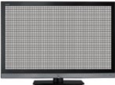
Full LED-Backlight: Um eine gleichmäßige, vollflächige Hintergrundbeleuchtung zu erreichen, wird hier eine LED-Matrix komplett hinter dem Panel hinterlegt. Auf diese Weise erreicht man eine Bildausleuchtung von über 90 Prozent.
