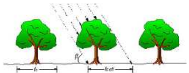
Figura 11. Esquema do cálculo da fração sombreada f_{c,eff} em função da fração coberta f_c e do ângulo do sol acima do horizonte \beta durante o período em que a ET é máxima (geralmente entre as 11 e as 15 h) (adaptado de Allen & Pereira, 2009)
