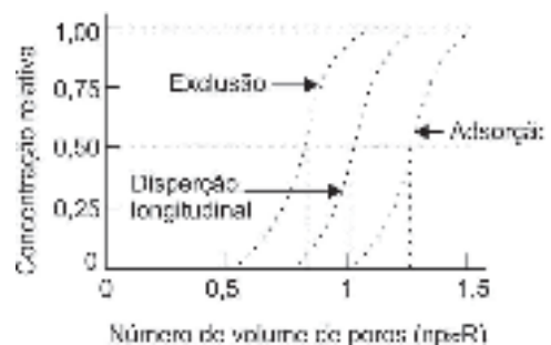
Figura 6. Curvas de efluentes para as situações em que ocorre dispersão-difusão com exclusão, dispersão-difusão apenas e dispersão-difusão com adsorção de um soluto em uma coluna de solo
