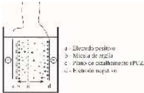
Figura 15. Separação iônica mostrando os eletrodos positivo e negativo, a micela e o plano de cisalhamento
