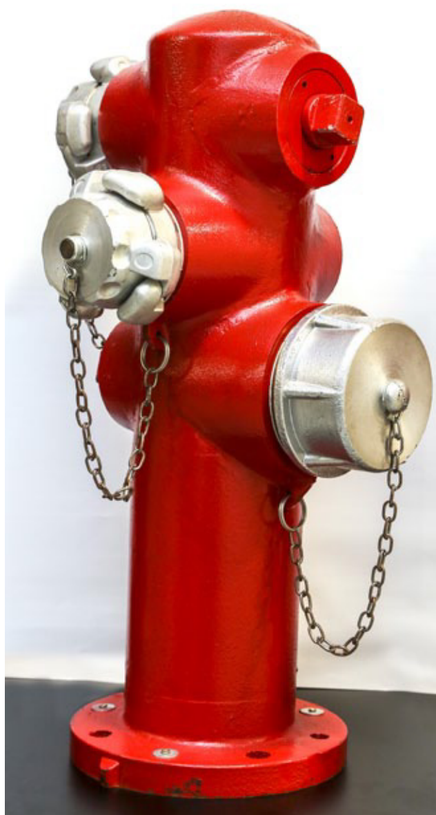
Hidrante de columna húmeda 100 mm, con dos salidas de 70 mm y toma de 100 mm para uso de los bomberos.
