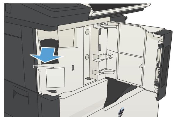
4. Heben Sie den Hebel vorne am Heftklammernmagazin an.
