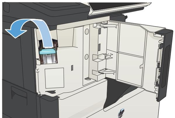
3. Entfernen Sie lose Heftklammern vollständig aus dem Gerät.
