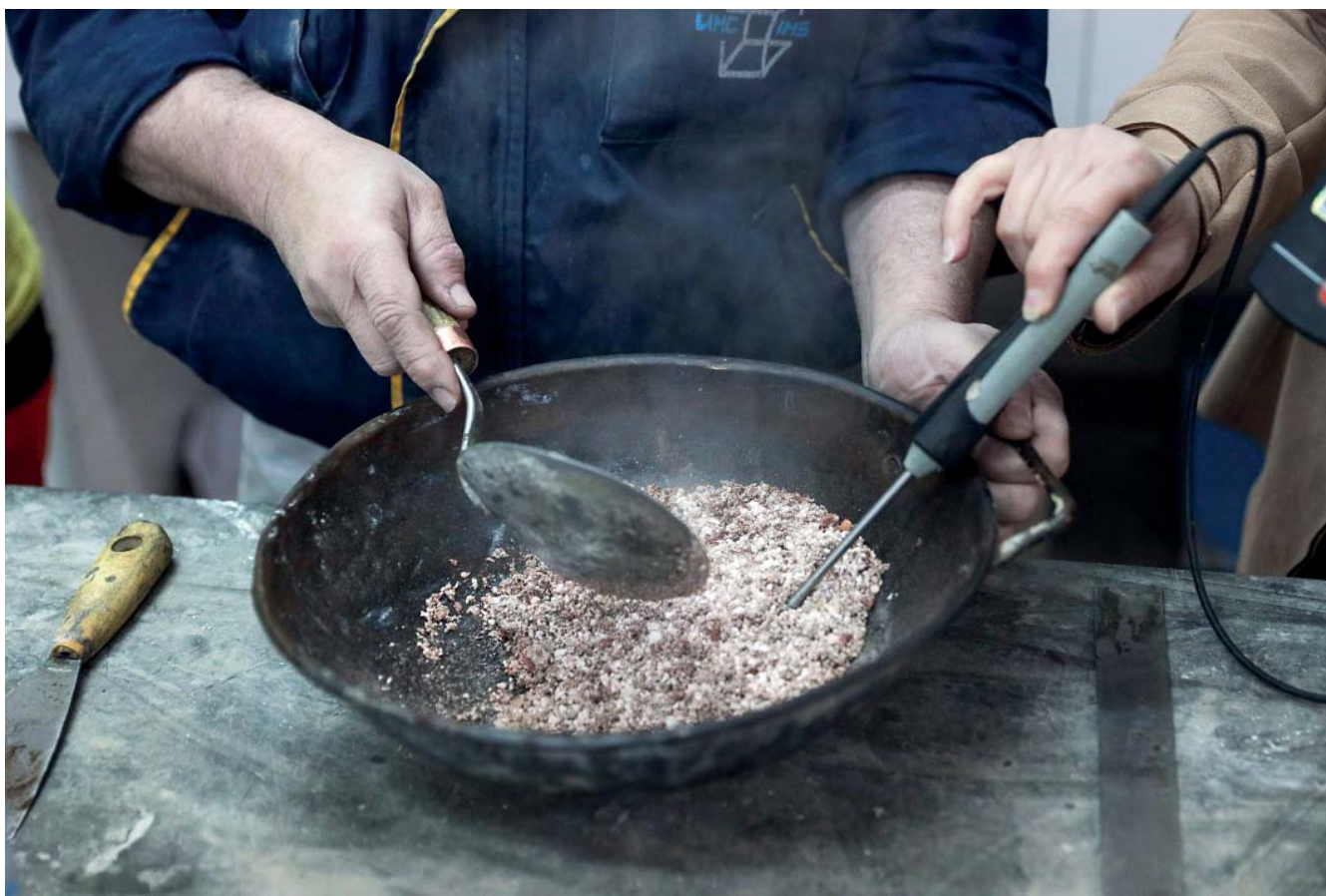
Мешање новог, компатибилног малтера у лабораторији Института ИМС
