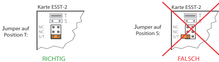
Fig. 24 Jumper-Position auf der Karte ESST
