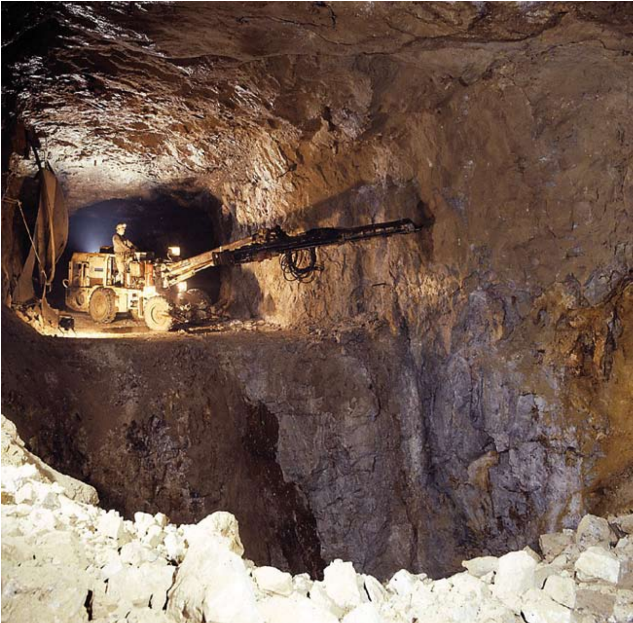
Abb. 176 Gewinnung von Fluorapat. Abbaukammer im Bergwerk Käfersteige bei Pforzheim (Foto 1990).
