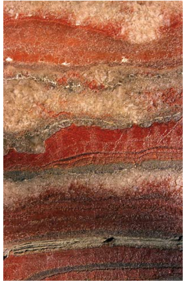
Abb. 84 Kalisalz aus Buggingen. Sylvin (rot), im schichtweisen Wechsel mit Steinsalz (weiß und hellgrau) (Bildbreite = 16 cm).
