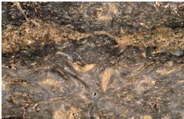
Abb. 33 Der in württembergisch Franken verbreitete sog. Krensheimer Quaderkalk im Oberen Muschelkalk besteht vornehmlich aus Muschelschalen und stellt einen beliebten Naturwerkstein dar (Bildbreite = 6 cm).
