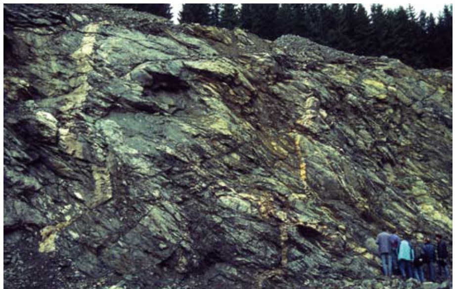
Abb. 38 Granitgänge (hellgelblich-grau) durchziehen dunkelgraue Paragneise und führen überwiegend zu einer Verbesserung der Materialeigenschaften hinsichtlich einer Verwendung im Verkehrswegebau. Steinbruch bei Bärenthal, südwestlich Titisee (RG 8114-1).
