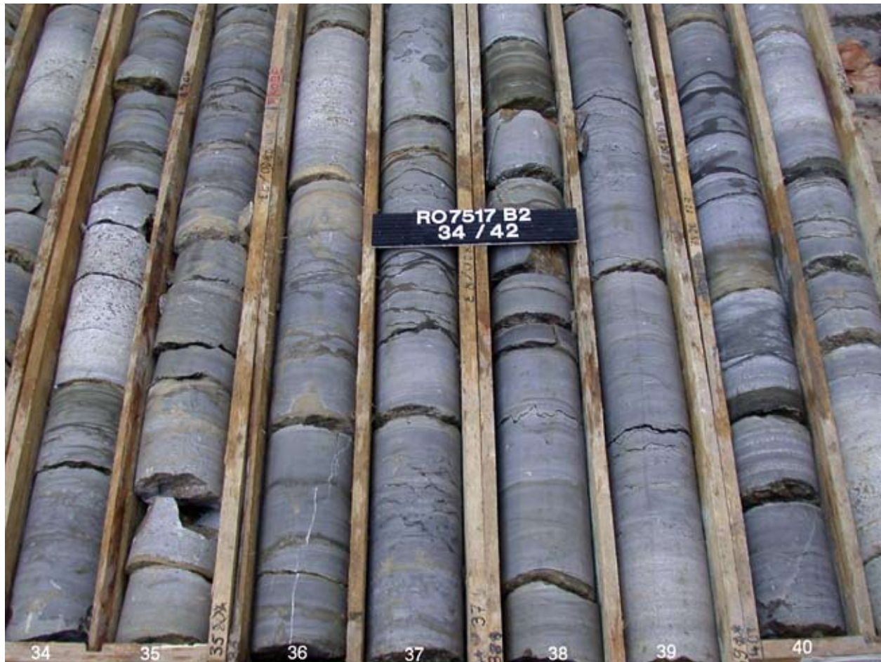
Abb. 187 Rohstofferkundung (3): Bohrkerne aus dem Oberen Muschelkalk (LGRB-Bohrung Ro 7517/B2 südöstlich von Dornstetten) – wichtige Grundlage zur Beurteilung von Rohstoffpotenzialen.
