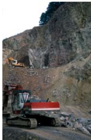
Abb. 37 Die nutzbare Mächtigkeit ist bei Gesteinen des Grundgebirges in den meisten Fällen lediglich durch die Lage des Grundwasserspiegels bestimmt, da ein Abbau im Grundwasser i. d. R. ausgeschlossen ist (RG 8212-1).
