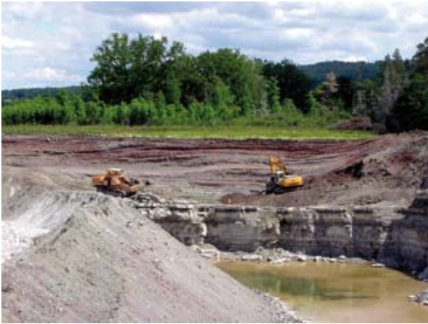
Abb. 161 Gewinnung von Gipsstein im Gipskeuper Frankens. Das hellgraue Sulfatgesteinslager ist von bunten Tonsteinen überdeckt. Gipsbruch bei Satteldorf (RG 6826-6).
