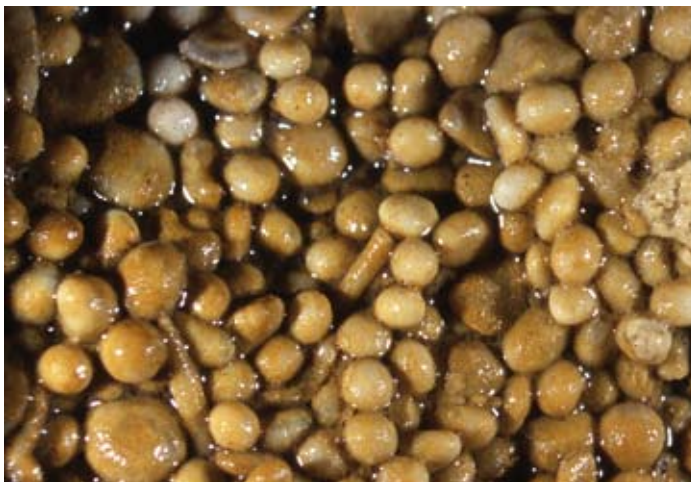
Abb. 29 Die industriell genutzten Kalksteinvorkommen im Braun- oder Mitteljura des südlichen Oberrheingrabens bestehen aus Kalkooiden (Durchmesser: ca. 1 mm), wie die mikroskopische Aufnahme zeigt. Probe aus dem Hauptrogenstein des Schönbergs bei Freiburg i. Br.
