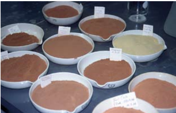
Abb. 141 Je nach Produktlinie werden unterschiedliche keramische Rohstoffe verwendet und in bestimmten Verhältnissen gemischt; jede Rohstofflieferung wird zuvor im Labor auf ihre Zusammensetzung und Eignung geprüft.
