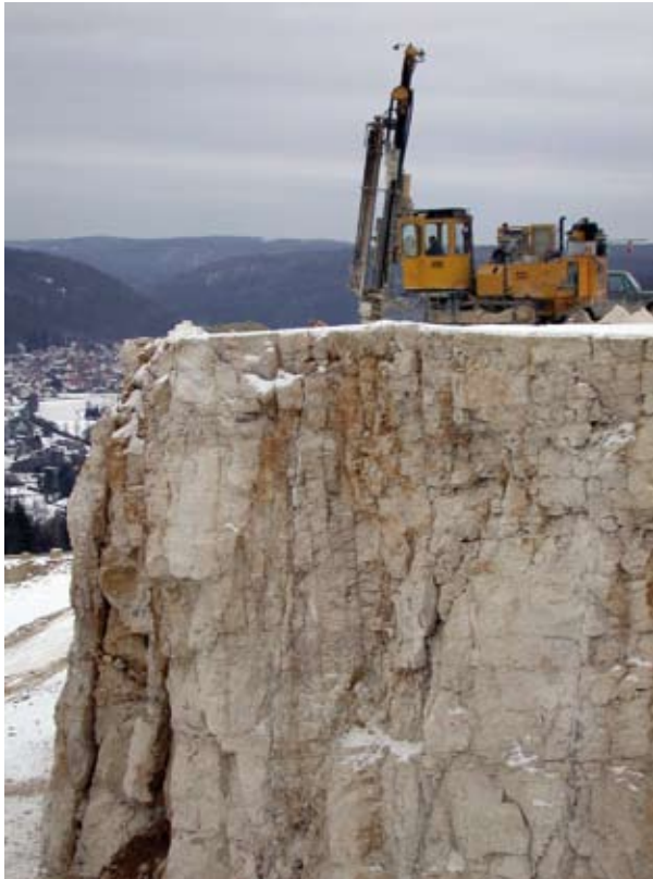
◀ Abb. 119 Kalksteinabbau auf der Schwäbischen Alb, Steinbruch bei Strassberg (RG 7820-2) – Bohren von Sprenglöchern.
