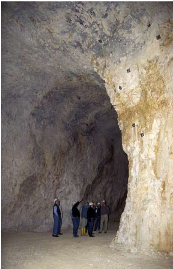
Abb. 158 Eine der ersten Abbaukammern im Bergwerk Mähringer Berg bei Ulm, wo künftig reine Kalksteine gewonnen werden sollen (RG 7525-11).
