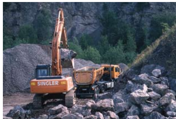
Abb. 126 Abbau von vulkanischen Gesteinen des Rotliegenden im Grundgebirge des Schwarzwalds. Die quarzreichen Porphyre erlauben die Erzeugung von widerstandsfähigen Körnungen für den Verkehrswegebau und von verwitterungsbeständigen Blöcken für Hang- und Uferbefestigungen (RG 7713-1).
