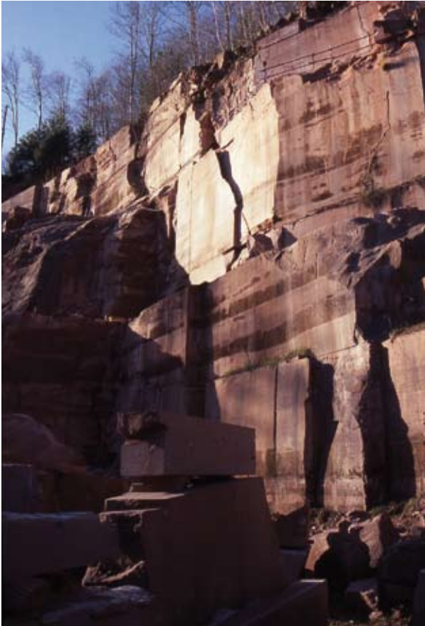
Abb. 57 Sandsteine des Buntsandsteins werden im Steinbruch bei Lahr-Kuhbach (RG 7613-3) gewonnen. Mit dem roten, gleichkörnigen Sandstein werden umfangreiche Sanierungsmaßnahmen an historischen Bauwerken wie dem Freiburger oder Basler Münster durchgeführt.
