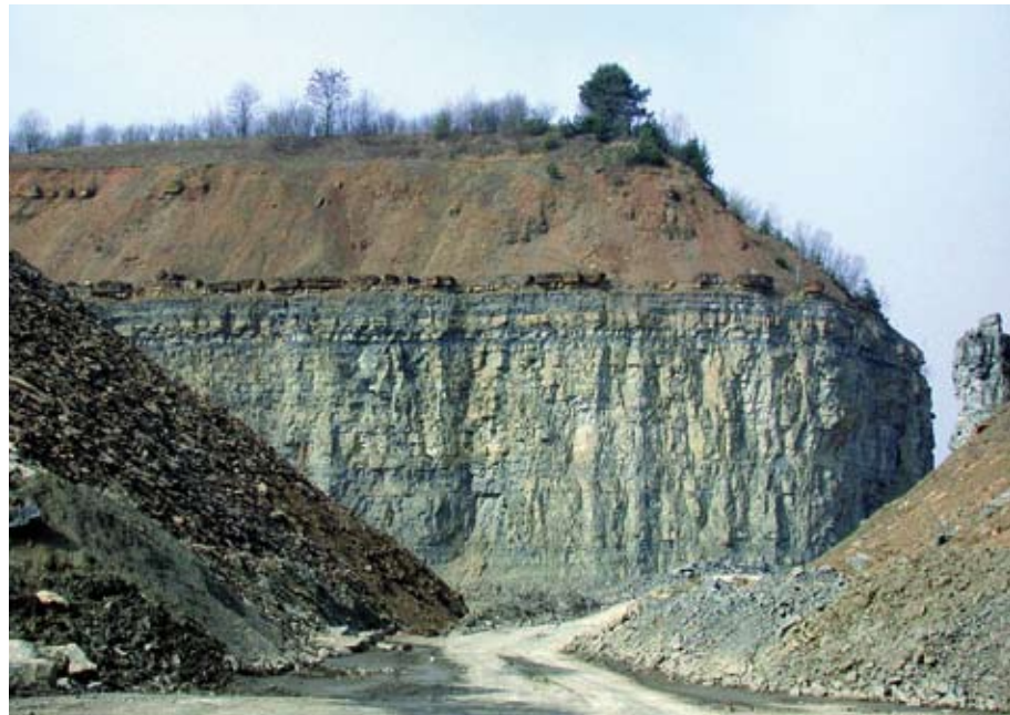
Abb. 125 Steinbruch im Oberen Muschelkalk bei Ittlingen (RG 6819-2). Die Nutzschicht wird im Erweiterungsgebiet von mächtigen Sedimentgesteinen des Keupers überdeckt.
