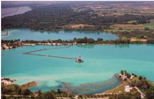
Abb. 3 Kiesabbau im Oberrheingraben bedeutet i. d. R. Nassabbau – Luftaufnahme im Gebiet Meißenheim, Ortenaukreis (Betriebs-Nr. RG 7512-2)*.
