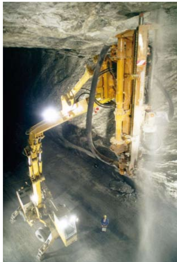
Abb. 168 Bohrlafette in einer Abbaukammer des Steinsalzbergwerkes Heilbronn.
