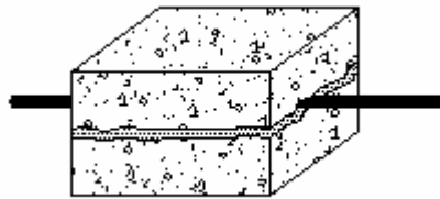
Figura 35.4 – Fendilhamento longitudinal do concreto
