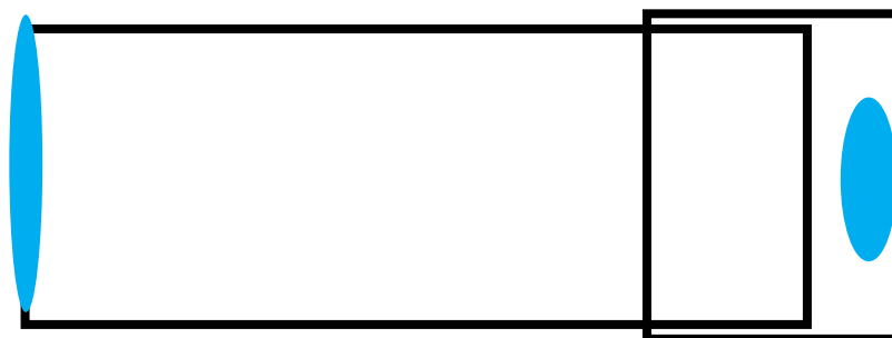
Obrázok 12: Schéma Keplerovho ďalekohľadu
