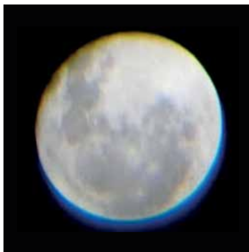
Obrázok 1: Farebná chyba pri pozorovaní Mesiaca
