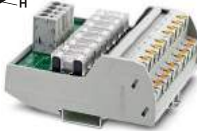
mit Push-in-Anschluss, 2 Potenzialebenen und acht 6,3-A-Sicherungen
