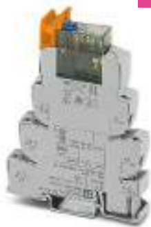
2-Wechsler-Relaismodul mit arretierbarer Handbetätigung, max. 2 x 50 mA
