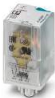
Oktalrelais mit zwei Wechslerkontakten mit Handbetätigung, max. 2 x 10 A
