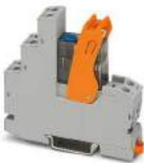
2-Wechsler-Relaismodul mit Schraubanschluss und Handbetätigung
