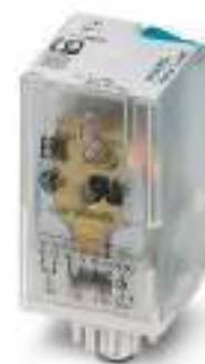
Oktalrelais mit drei Wechslerkontakten mit Handbetätigung, max. 3 x 10 A
