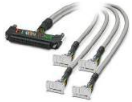
Steckverbinder Fujitsu FCN auf IDC/FLK-Buchsenleiste, Polzahl: 40 auf 4 x 14
