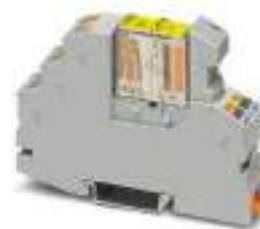
2-Wechsler-Relaismodul mit zwangsgeführten Kontakten, max. 2 x 6 A
