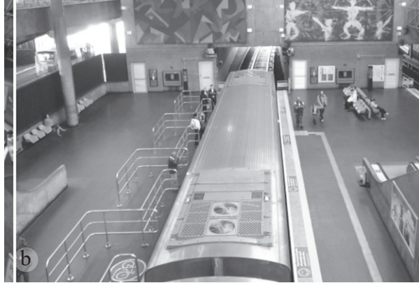
Figura 7 – Plataforma da Estação Palmeiras-Barra Funda Plataformas da estação em maio de 2004 (a) e em junho de 2011 (b) após a instalação de elementos organizadores de embarque, sinalização tátil no piso para orientação dos deslocamentos de pessoas com deficiência visual e demarcação do local de embarque de ciclistas. Fonte: Beltrame, R. (a) mar.2004; Barbosa, M.B (b) jun.2011.
