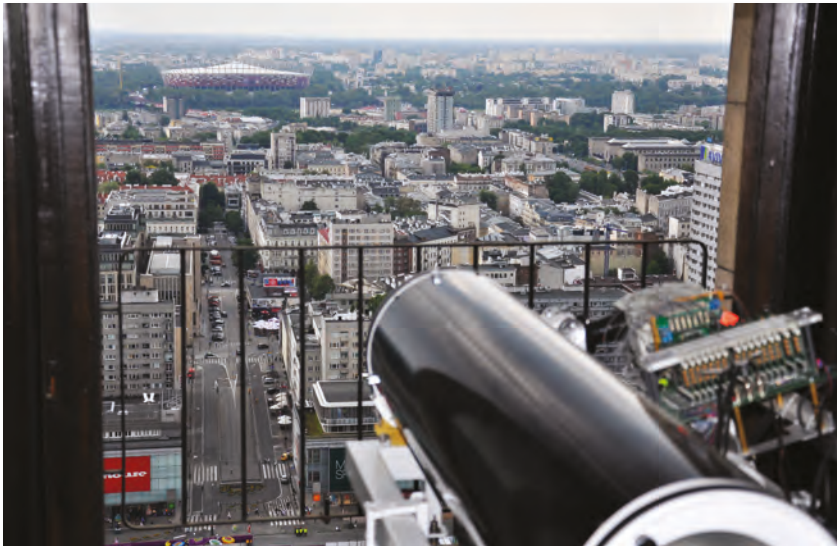
Specjaliści z IOE z 27. piętra Pałacu Kultury i Nauki monitorowali rejon Stadionu Narodowego oraz strefę kibica przy użyciu dwóch systemów lidarowych: bliskiego i dalekiego zasięgu
