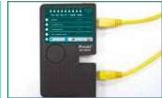
RJ45 Lan cable test
