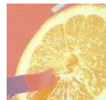
Слика 4.6. Плава лакмус хартија мења боју у црвено у присуству лимунске киселине
