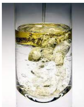
Слика 1.3. Уље има мању густину од воде и зато „плива“ на површини воде.
