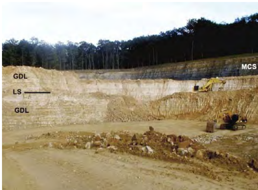
Fig. 2: Aspect de la partie supérieure de la carrière de Brouch (juin 2009) montrant la séquence supérieure du Grès de Luxembourg (GDL) avec la lumachelle à Schlotheimia (LS), surmontée des Marnes et Calcaires de Strassen (MCS).
