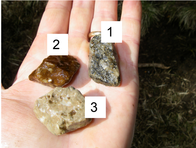
Figur 4. Bilden visar tre gruspartiklar som legat i Kattån i Västra Götalands och Jönköpings län under 1 år. Nr. 1 är en naturlig gruspartikel. Nr. 2 är krossad kalksten med pålagring. Nr. 3 är krossad kalksten där pålagringarna manuellt skrubats bort.
