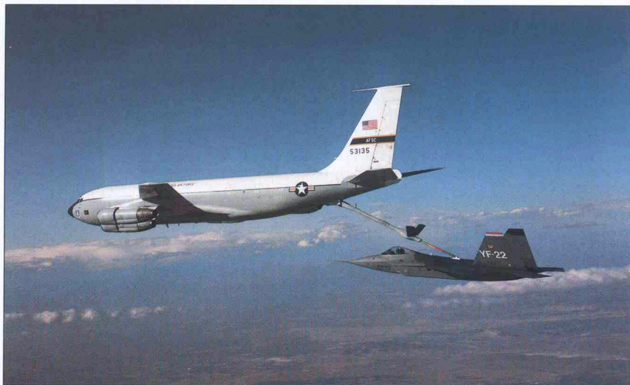
Primer ensayo de reabastecimiento en vuelo de un prototipo YF-22, desde un KC-135. Este ensayo se considera crítico para el sistema de mandos de vuelo.
