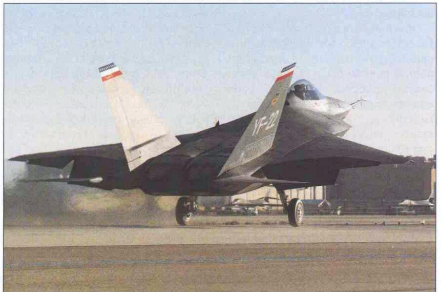
Segundo prototipo YF-22 en despegue, mostrando las toberas bidimensionales, con control vectorial del empuje, del motor F-119 de P&W
