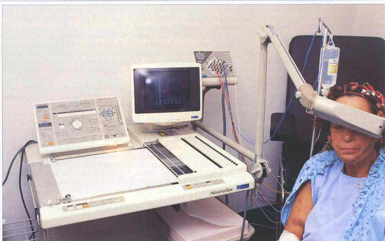
Figura 1. Electroencefalógrafo de 22 canales programables (la información de recogida del registro se refleja en el monitor del aparato). Nótese la disposición de la paciente para la fotoestimulación.
