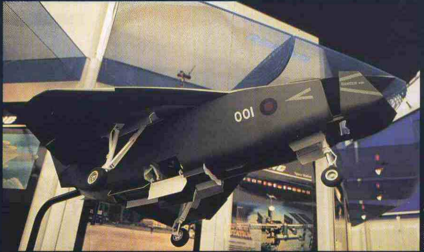
En esta fotografía de la maqueta del JSF de Boeing presentada en Farnborough '96 se aprecian las aperturas en la parte inferior del fuselaje para las toberas orientables y la pantalla de aire, así como la toma frontal en posición de máximo desplazamiento.
