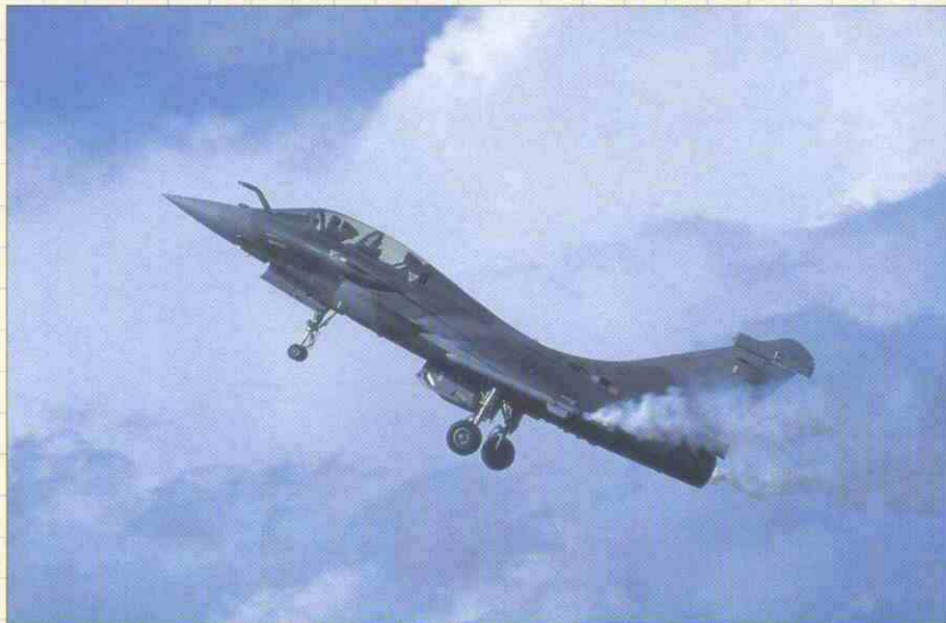
El Rafale francés volando con gran ángulo de ataque, tal y como delata la trayectoria del humo.
