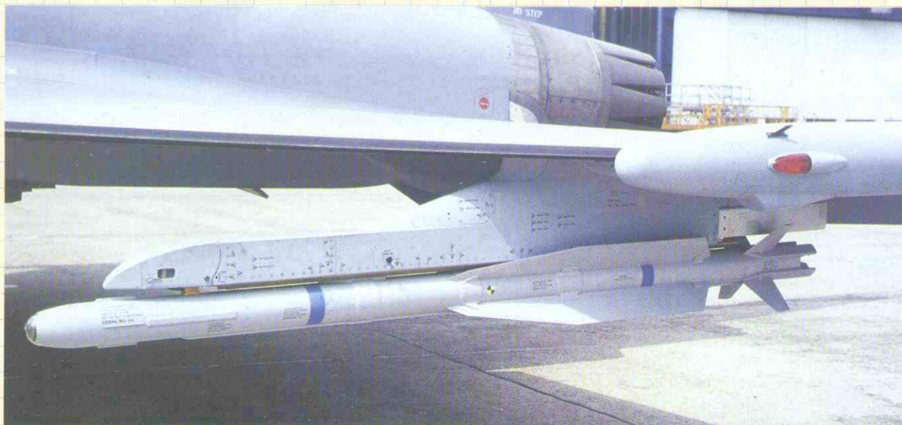
Iris-T. Estará integrado en el EF-2000, Tornado, Jas 39 Gripen, AMX, F-16 y CF-18.
