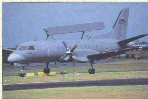
Saab 340 con la antena de su radar Erieye sobre el fuselaje
