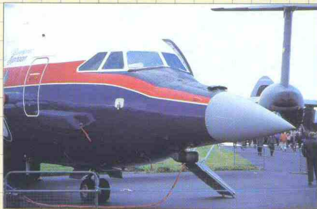
Morro de un BAC 1-11 modificado para albergar el radar del EF-2000.
