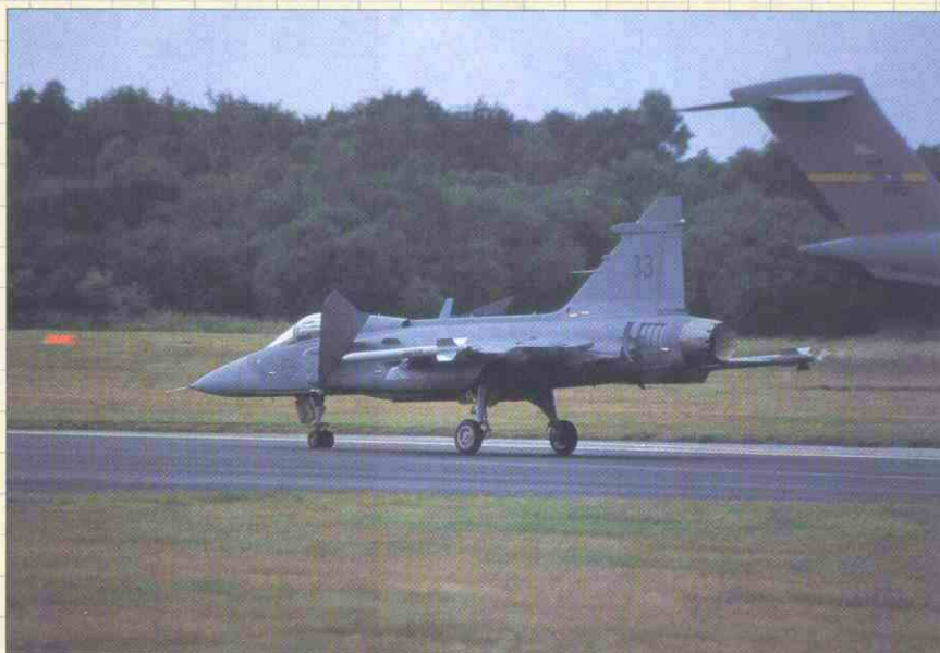
El Gripen sueco apura la frenada en su toma ayudado por sus aerofrenos y la máxima deflexión de sus foreplanes.
