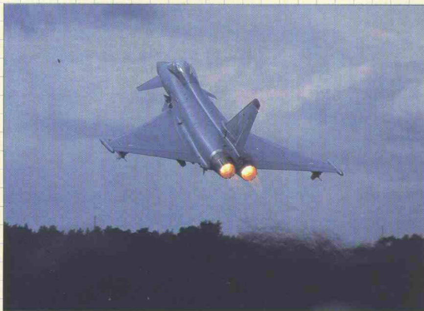
El EF-2000 alcanza las 40.000 Lbs. de empuje gracias a sus motores EJ-200.
