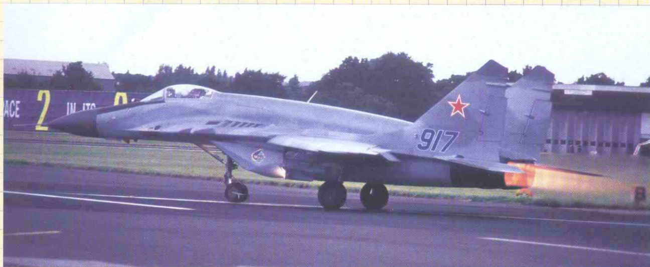
El MiG-29 SMT en carrera de despegue. Obsérvese la nueva fisonomía exterior causada por la adición de nuevos depósitos de combustible tras la cabina.
