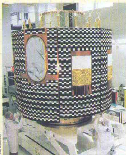
Meteosat de Segunda Generación (MSG), que sustituirá a los satélites de observación meteorológica actuales. Está previsto el lanzamiento de dos satélites MSG, uno el año 2002, y otro el año 2007.
