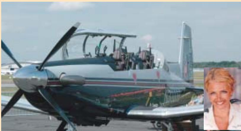
Con idea de cubrir las fases 2 y 3 de formación de pilotos, Pilatus mostró las excelentes capacidades y equipación de su prototipo del modelo PC-21. Incluye un motor de 1600 shp fabricado por Pratt & Whitney y una aerodinámica que le permite operar normalmente en velocidades entre 300 y 400 Kts, alcanzando hasta 38.000' de techo. Cuenta asimis-
