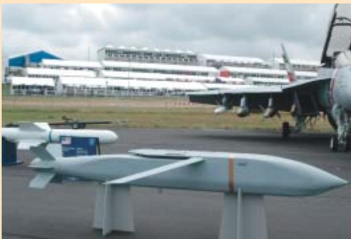
primeras versiones se guían únicamente por INS/GPS mientras que la última versión dispone también de un sensor de imágenes infrarrojas para la fase terminal de guiado. El alcance de este tipo de armas varía, según el fabricante, desde las 12 NM a baja cota hasta 70 NM en lanzamientos desde alta cota. Es destacable que en la parte trasera tiene espacio disponible para integrar un motor de tipo turbojet que le proporcionaría un alcance y una capacidad de penetración adicional.
