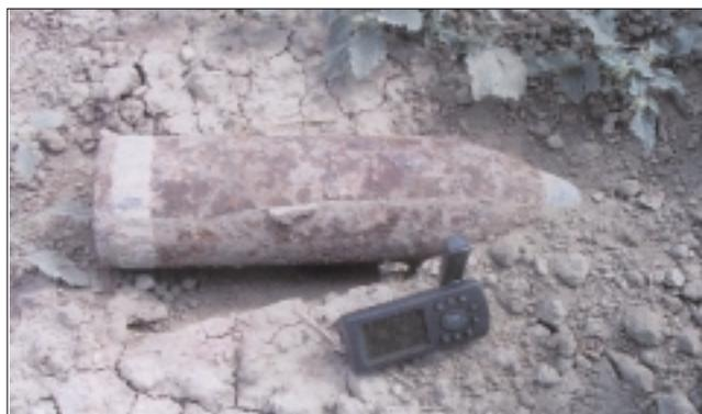
*Estado en el que apareció el proyectil. El cuerpo estaba totalmente oxidado, en el que se aprecia perfectamente la banda de forzamiento y la espoleta. El GPS (Sistema de Posicionamiento Terrestre) pertenece al equipo EOD, no apareció con la bomba...*
