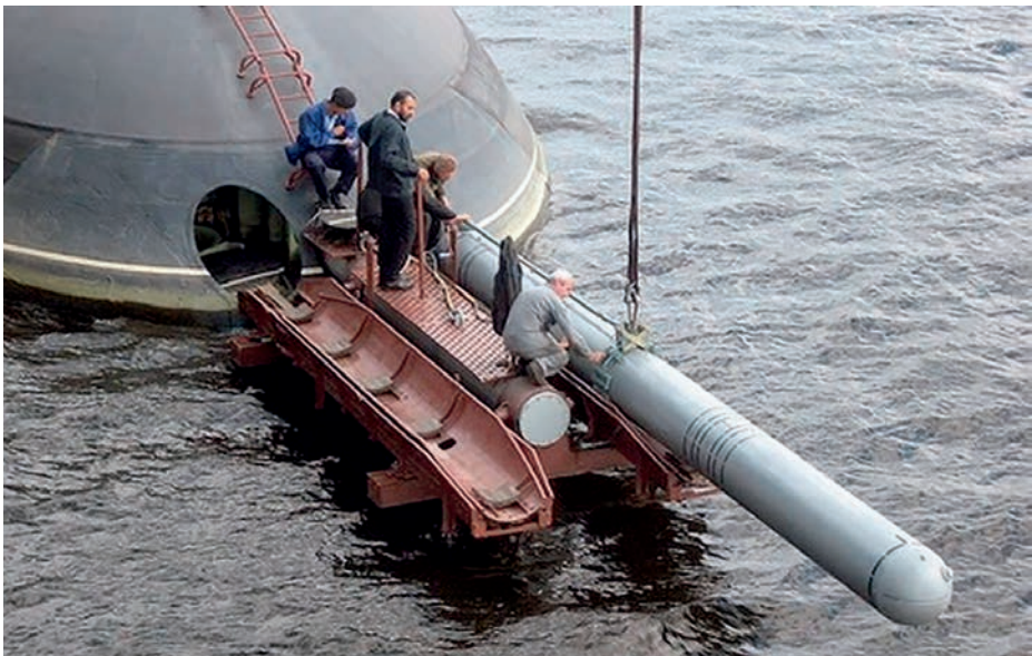
Carga de misil de crucero Kalibr en un SSG clase Kilo II . (Fotografía facilitada por el autor)
