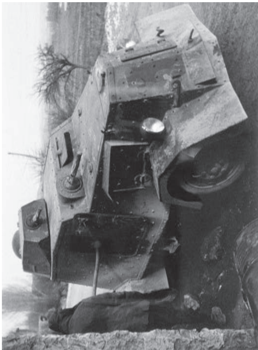
Uno de los numerosos blindados ZIS/Ford 85, fabricados en España con tecnología, materiales y apoyo soviético
