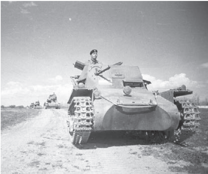
Uno de los carros enviados a España por los teutones fue el carro de mando Panzerbefehlswagen I-A mostrado en la fotografía
