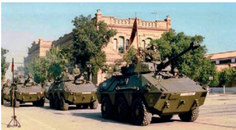
VEC del Regimiento Sagunto. Sobre 1988 recibieron la torre de las antiguas AAML H-90 (foto Veteranos del Sagunto)
