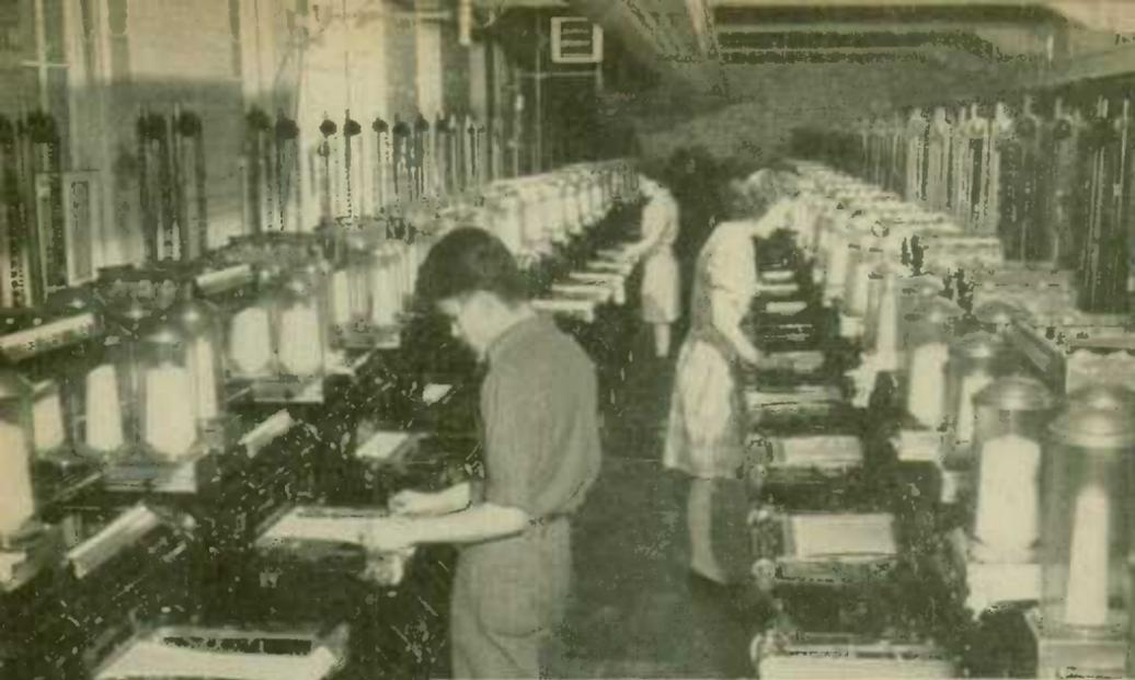
Fabrication des bas dans une manufacture de l'Ontario. Ces tricoteuses à section et tête uniques font des bas entièrement diminués de standard 54. Chaque machine produit deux bas par heure.
