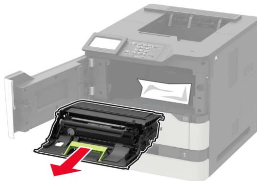
**Warnung—Mögliche Schäden:** Setzen Sie den Fotoleiter nicht länger als zehn Minuten direktem Licht aus. Wenn es zu lange dem Licht ausgesetzt ist, kann dies zu Problemen mit der Druckqualität führen.
