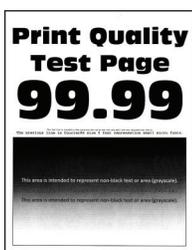
**Hinweis:** Drucken Sie die Testseiten für Druckqualität aus, bevor Sie das Problem beheben. Gehen Sie an der Bedienerkonsole zu **Einstellungen > Fehlerbehebung > Testseiten für Druckqualität**. Drücken Sie bei Druckermodellen ohne Touchscreen
