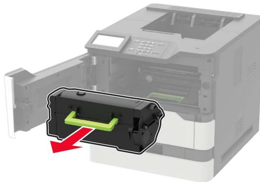
3 Entfernen Sie die Belichtungseinheit.
