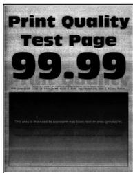
**Hinweis:** Drucken Sie die Seiten für Druckqualitätstests aus, bevor Sie das Problem beheben. Gehen Sie an der Bedieneinheit zu **Einstellungen > Fehlersuche > Testseiten für Druckqualität**. Drücken Sie bei
