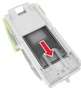
**Hinweis:** Wenn sich die Heftklammern an der Rückseite der Tonerkassette befinden, schütteln Sie die Kassette nach unten, um die Heftklammern in die Nähe der Metallhalterung zu bringen.
