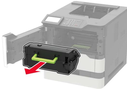
**3** Entfernen Sie die Belichtungseinheit.
