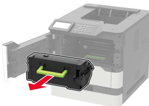
**3** Entfernen Sie die gebrauchte Belichtungseinheit.
