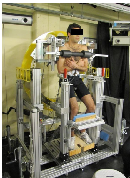
Figure A.8: Dynamomètre pour mesurer les efforts maximaux des muscles du tronc.
