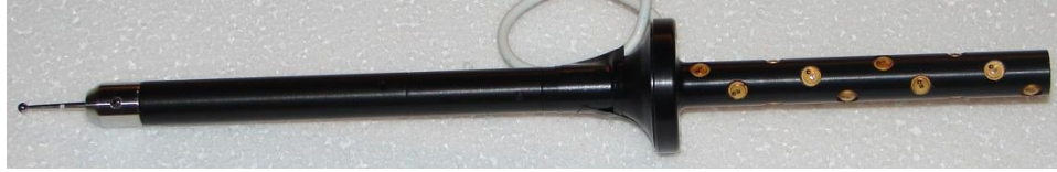
Figure A.5: Pointeur (la probe) pour mesurer les coordonnées des points quelconques sur la peau dans système globale.
