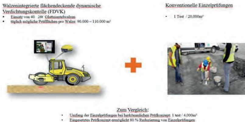
Abbildung 2. Angewendetes Prüfkonzept zur Überwachung der Qualität verdichteter Lagen.
