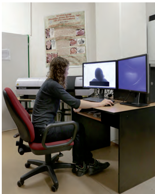
Obr. 27. L. Váchová během práce na microCT SkyScan 1172, používaném pro nedestruktivní výzkum vnitřní stavby sbírkových předmětů. Foto: J. Sklenář.
