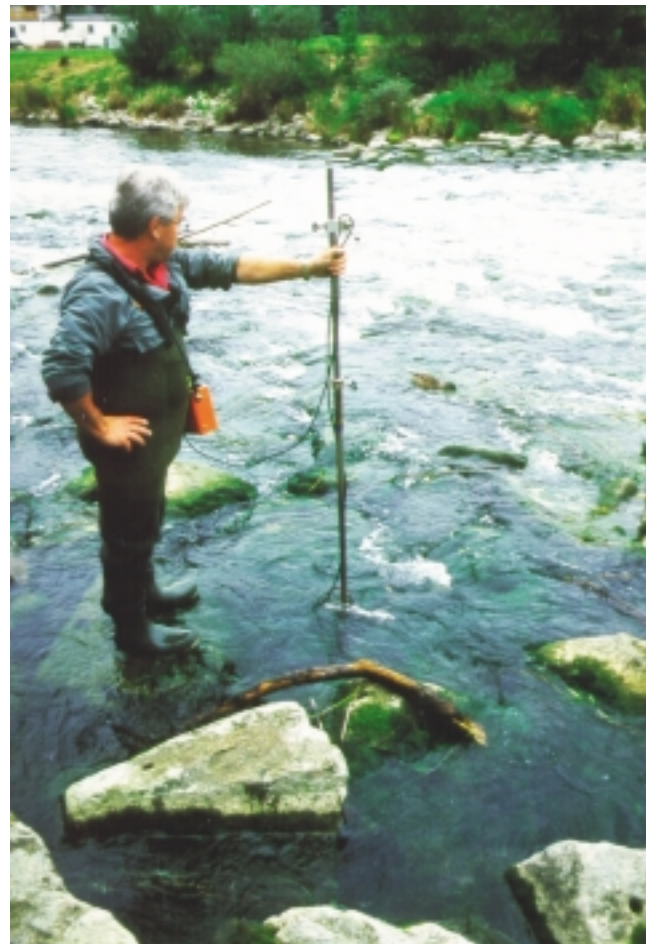
Abb. 10: Strömungsmessungen an einer Sohlrampe werden z.B. als Planungsgrundlage für die naturnahe Gewässerentwicklung gebraucht.
