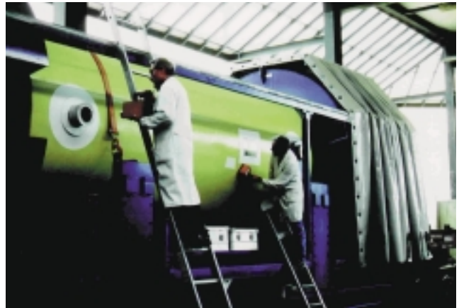
Abb. 1: Die LfU überprüft Transportbehälter für hochradioaktive Abfälle aus kerntechnischen Anlagen auf die Einhaltung von Strahlenschutzbestimmungen.
