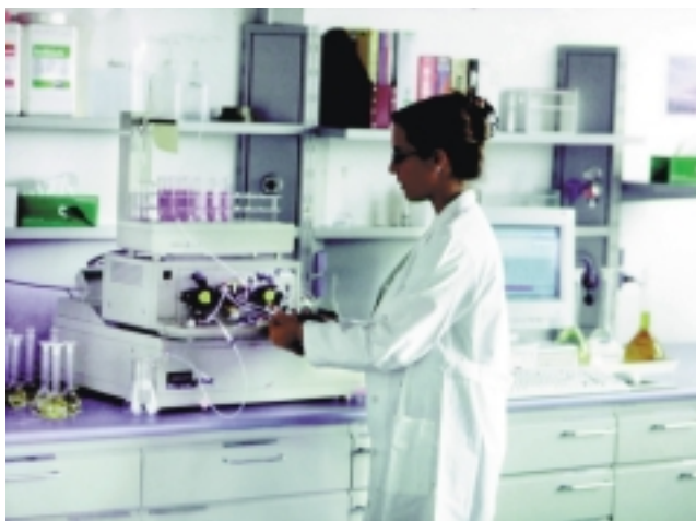
Abb. 1: Fließinjektions-Fotometriesystem im Chemischen Zentrallabor der LfU.
