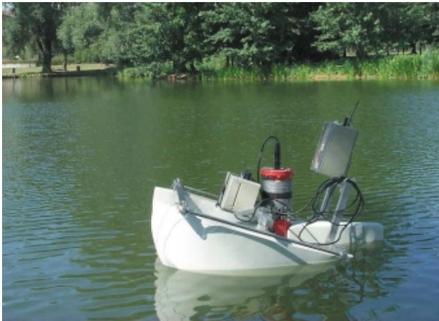
Abb. 5: Mit diesem quer über das Fließgewässer gezogenen Gerät lässt sich die Fließgeschwindigkeit und die Wassertiefe mittels Ultraschall in kurzer Zeit bestimmen.
