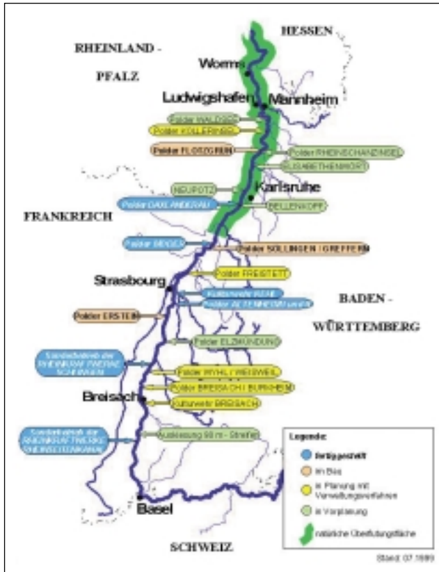
Abb. 3: Hochwasserrückhaltmaßnahmen am Oberrhein zwischen Basel und Mannheim.
