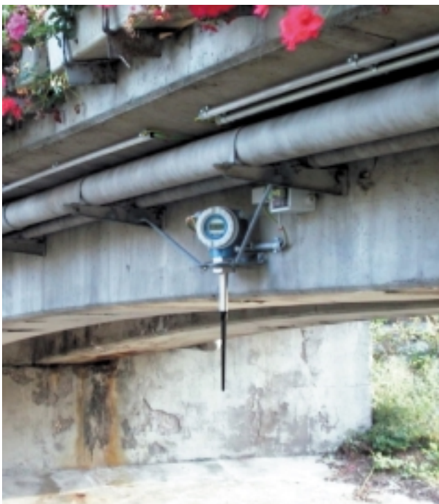
Abb. 4: Unauffällig unter einer Brücke montiert misst das Radargerät kontinuierlich den Wasserstand der Weschnitz bei Weinheim.
