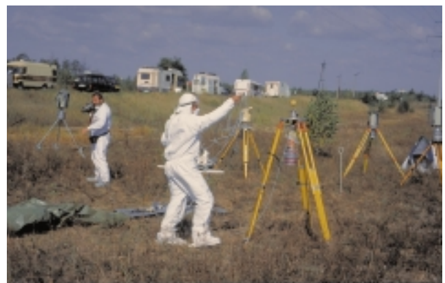
Abb. 6: Messungen im Bereich hoher Dosisleistung mit kollimierten Detektoren.
