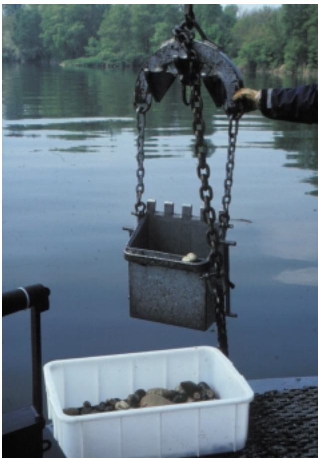
Abb. 6: Mit Hilfe von Dredgen kann der Flussboden auf seine Beschaffenheit und seine Besiedlung untersucht werden.
