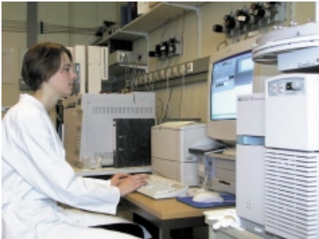
Abb. 3: Modernes Gaschromatografie/Massenspektrometrie-Analysensystem für die organisch-chemische Spurenanalyse.
