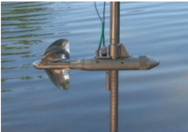
Abb. 3: Hydrometrischer Flügel zur Messung der Fließgeschwindigkeit. Die Geschwindigkeit ergibt sich aus der Umdrehungsgeschwindigkeit der Flügelschaukel.
