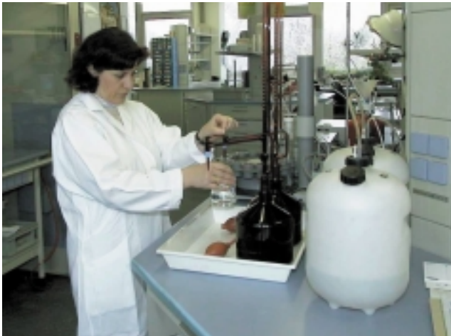
Abb. 2: Klassische Maßanalyse mit Titration bei der Bestimmung des Permanganat-Index.
