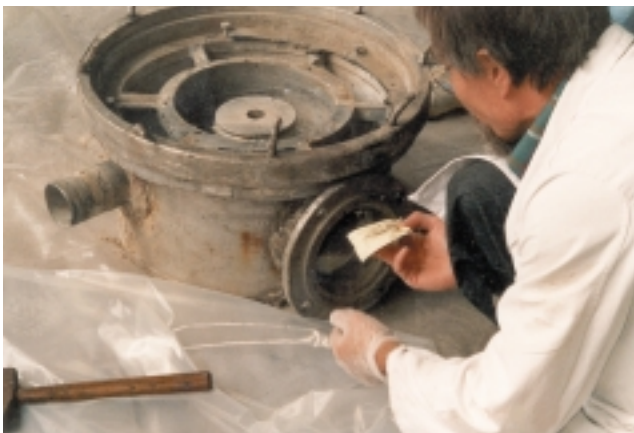
Abb. 1: Untersuchung eines kontaminierten Metallschrottteils mittels Wischtest.
