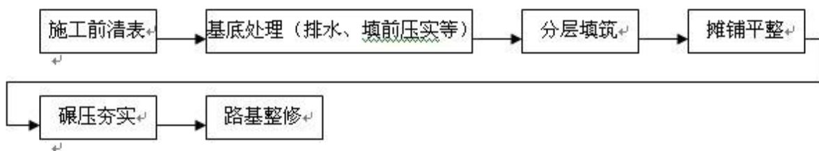
图 2.7-2 路基工程施工工艺图
