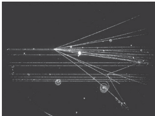
Figura 7. Registro de una interacción en la cámara de burbujas de 2m del CERN.
