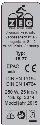
Typenschild des Typs 15-77 (Bulls Green Mover Lavida)
