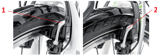
1 Schnellspannhebel vorne 2 Schnellspannhebel hinten
