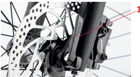
1 Hebel (Einstellmutter auf gegenüber liegender Seite)
