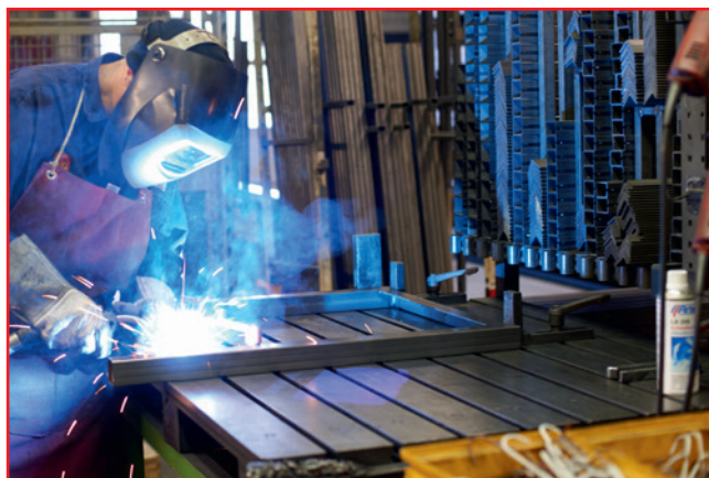
Schweiß-Arbeitsplätze Herstellung von Werkbankgestellen, Fahrgestellen u.v.m.
