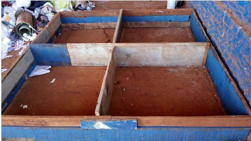
Figura 14. Método de quartejamento de resíduos 2m X 2m
