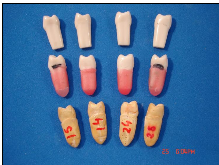
Figura 26: Elementos dentarios preparados y duplicados
