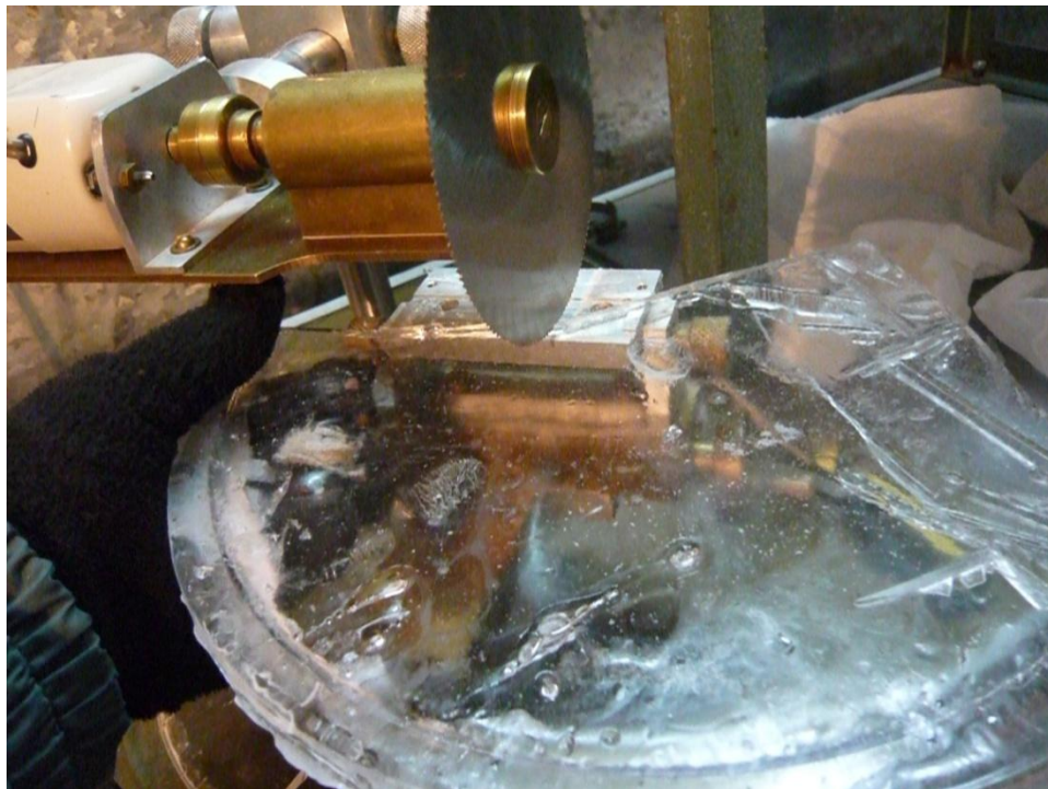
Figura II.2: Realización de los cortes al bloque de hielo.
