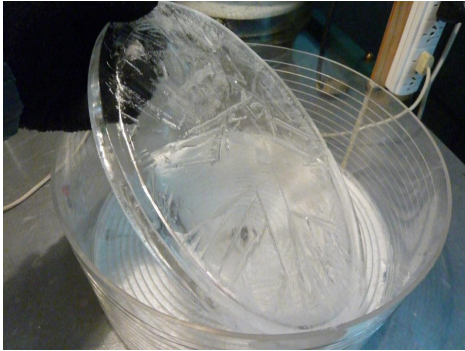
Figura II.1: Extracción del bloque de hielo cilíndrico de la celda para la obtención de monocristales.
