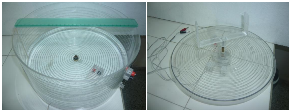
Figura II.7. Izquierda: celda de crecimiento de alta pureza, en el centro de la base puede notarse el contacto térmico donde se adhieren las semillas. En la parte superior se ha colocado una regla de 30 cm de largo para apreciar la escala. Derecha: Tapa de la celda con paletas giratorias.
