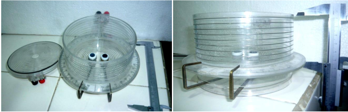
Figura II.4. Celda para crecimiento de monocristales y bicristales, vistas superior y lateral.
