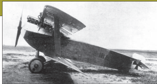
8. ábra. A 161.01-es UFAG C.I prototípus 1917 nyarán Aspernbén. A gép még a keskeny, mély törzzsel, kis oldalkormányokkal és „I” alakú szárnymervítőkkel épült (Grosz-Haddow-Schiemer, 291. o.)
