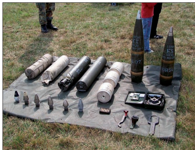
3. ábra. Modern löszerkészlet PzH 2000 tarackágyúhoz. Jól megfigyelhetőek a löszer részei: a lövedék, hajtótöltet és gyújtó
