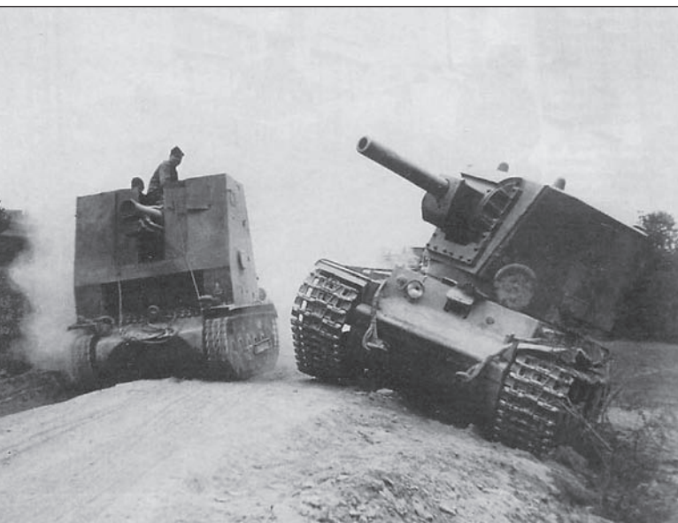
2. ábra. Elhagyott KV-2 az út szélén a balti régióban 1941. június. A harckocsi mellett egy német sIG 33 150 mm-es önjáró löveg halad el
