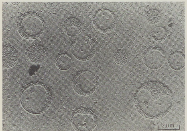
3. ábra. Az 1150 °C olvasztott és 0,1%-os hidrogén-fluorid oldattal 5 másodpercig maratótt üvegről készült replika elektronmikroszkópos képe
