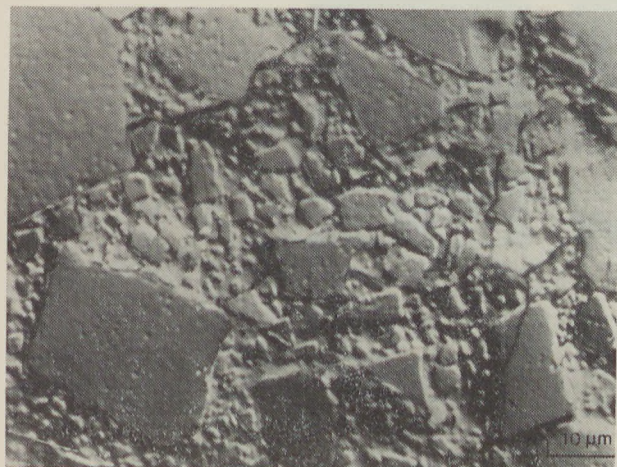
8. ábra. 1150°-on olvasztott G200 üveget tartalmazó ASPA cement polírozott és maratott felszíne optikai mikroszkóp alatt, Nomarski-féle interferencia feltétellel
