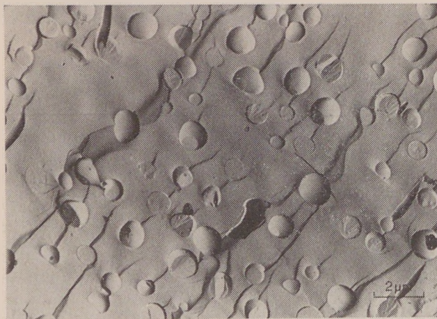
5. ábra. A 1200 °C olvasztott G200 üveg törési felületéről készült replika elektronmikroszkópi képe. Maratás 0,1%-os hidrogén-fluorid, 5 másodperc
