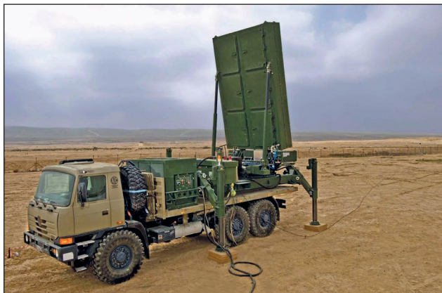
1. ábra. Az ELM–2084 MMR radar, terepjáró tehergépjárműre telepítve [2]
