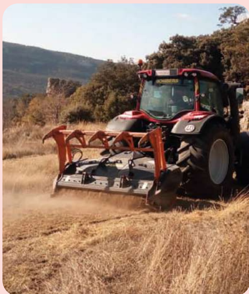
Imatge 94. - Tractor executant franja de seguretat contra fugites de foc (sense vegetació). Font: GVA.
