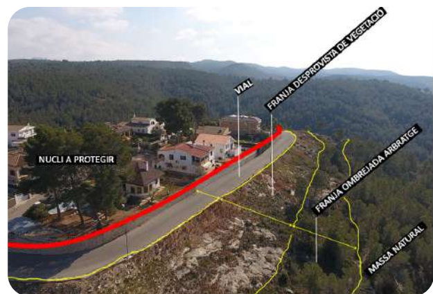
Imatge 89. - Franja perimetral de seguretat d'una urbanització en contacte amb la forest. Font: Medi XXI GSA.
