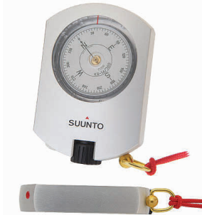
SUUNTO - KB14 FIN 31001 € 158,00 Bussola 360° a traguardo diretto. Scatola in Dural anticorrosione. Quadrante a bagno d'olio. Precisione: 1/2 grado. Peso: 115 g.
