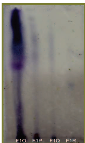
Figura 4.8: Cromatograma de las sub-fracciones provenientes de F 1 en el sistema B, revelado con el reactivo vainillín sulfúrico.
