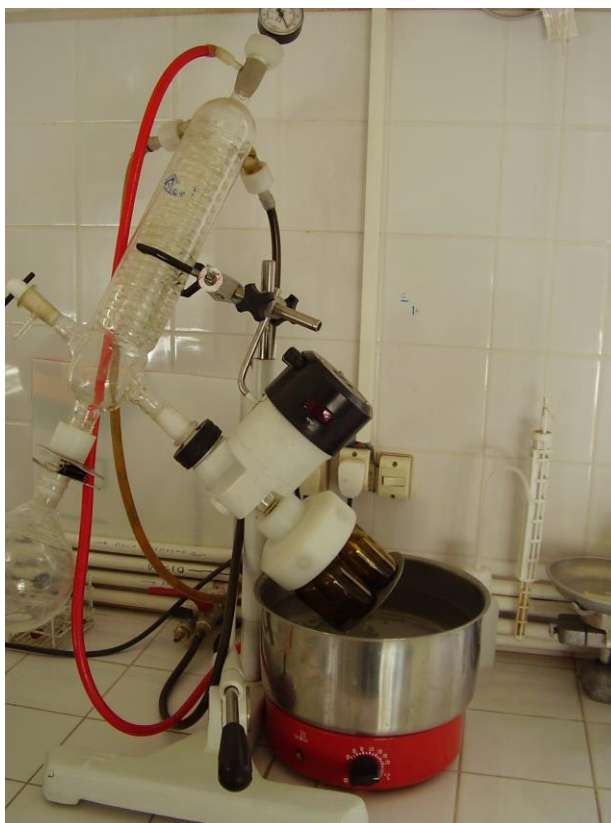
Fig 5: Extractos llevados a sequedad en rotavapor. Nota: la innovación que se muestra en esta Figura consiste en el adaptador para desecar en frasco ampolla de 50 mL alícuotas correspondientes al extracto hidroalcohólico proveniente de 20 g de partes aéreas secas de cada planta. Estos extractos fueron resuspendidos en metanol y desecados utilizando el mismo adaptador en frasco ampollas de 10 mL para obtener el Extracto Metanólico Desechado.
