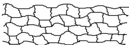
Abbildung 2.1: Engmaschig vernetzte Makromolekülketten [Bri14]
