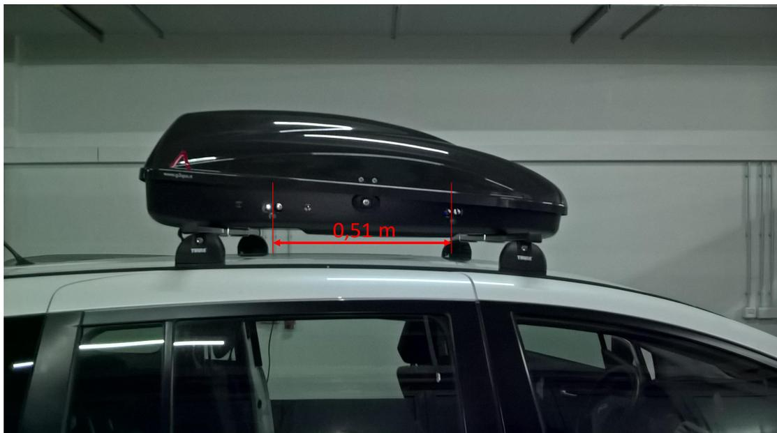
Abbildung 5.3.: Sensorsystem auf Autodach montiert
