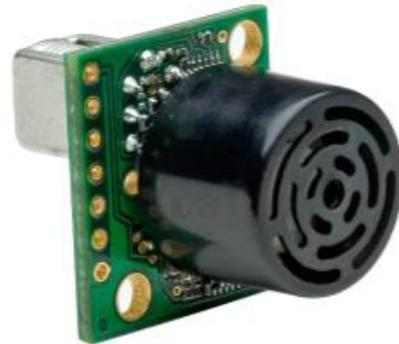
Abbildung 5.9.: XL-MaxSonar - AE Serie von *MaxBotix Inc.* Bild aus Datenblatt [16]
