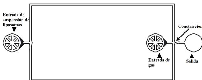
Figura 2.13: Esquema del diseño del dispositivo empleado para la fabricación de microburbujas.
