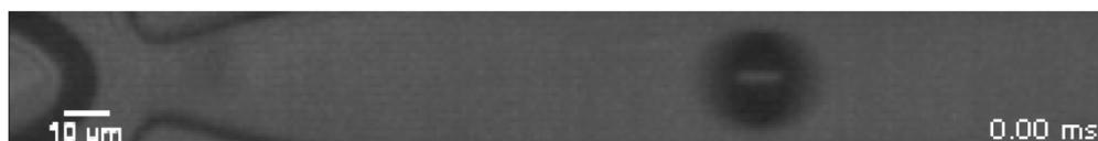
Figura 3.11: Imagen capturada con la cámara rápida. Se muestra la constricción donde se juntan la fase gaseosa (lado izquierdo) y la acuosa; también se aprecia una burbuja avanzando hacia la salida.
