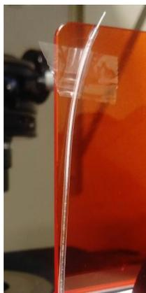
Figura 3.12: Manguera con microburbujas atrapadas. La manguera está colocada de manera vertical por lo que las burbujas se concentran en la parte superior.
