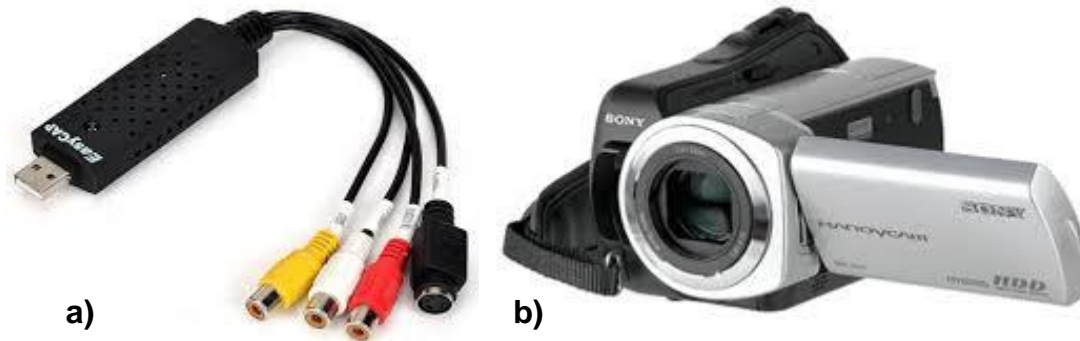
Figura 15 a) Tarjeta para la adquisición de imágenes por medio de USB, b) Videocámara DCR-SR45 de SONY.
