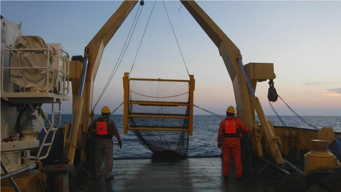
Figura 6. Red de trineo bentónico utilizado en campañas oceanográficas en el Cinturón Plegado Perdido.
