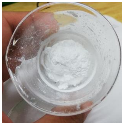
Figura 14. Aspecto de la muestra después de la síntesis por combustión luego de enfriarse.
