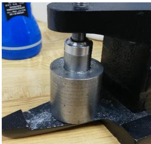
Figura 15. Imagen de prensa metálica ejerciendo presión sobre polvos.
