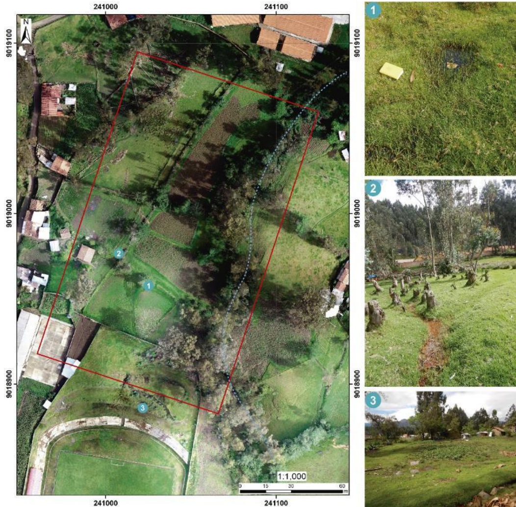
Figura 21: Imagen de la derecha. Área denominada como levantamiento fotogramétrico N°1; 1) Ojos de agua; 2) Canales de riego no impermeabilizados; 3) Se aprecia entrapamientos que favorecen la infiltración de aguas superficiales y saturación de los suelos.
