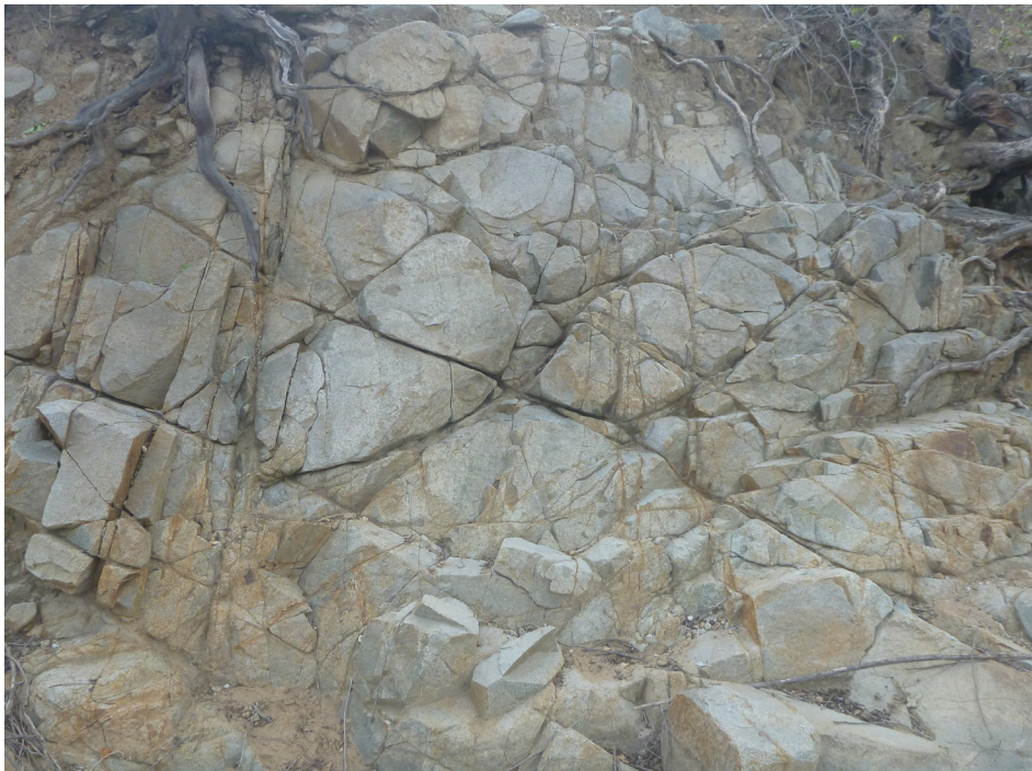
Fotografía 3.21 Diorita fuertemente fracturada con relleno de óxidos de hierro. Localidad de Carrizalillo (coordenadas UTM WGS84: 9491628 N, 576668 E)
